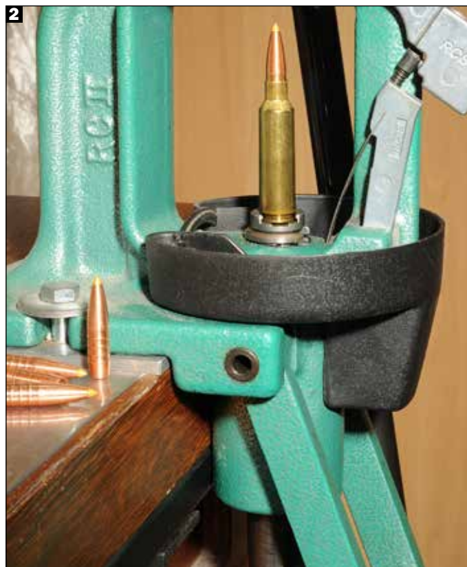
1. Proiettile monolitico calibro .308 in lega di rame prodotto dalla Mrr serie Green hunting del peso di 167 grani e cartuccia calibro .300 Wsm allestita per le nostre prove. Il proiettile Mrr è stato crimpato sulla prima corona di forzamento e ha una altezza totale di 74,10 mm. 2. Le operazioni di caricamento delle palle Mrr Green hunting di 167 grani allestite con pressa monostazione della Rcbs. 3. Proiettile Mrr Green hunting del peso di 167 grani, dopo lo sparo. A sinistra, sparato alla velocità di 886 m/sec e a destra, sparato alla velocità di 884 m/sec. Notare il notevole affungimento dell'ogiva e la corretta apertura dei petali.
